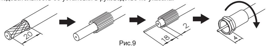
6. Соедините вилку F-типа подготовленного кабеля с F-розеткой на монтажной коробке антенны.
