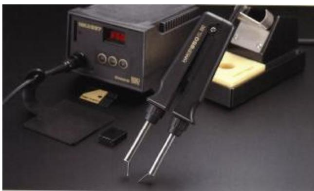
Он легко удаляет SMD чипы и микросхемы в плоских корпусах до 25 мм. Термопинцет Hakko 950 может применяться в станциях 936, 937, 928 вместо паяльника простой заменой в тот же разъем. Основой термопинцета являются два керамических стержневых нагревателя, аналогичных применяемым в паяльниках. Основные технические характеристики - такие же, как у паяльников. Цанговые зажимы обеспечивают легкость смены и выравнивания наконечников.
