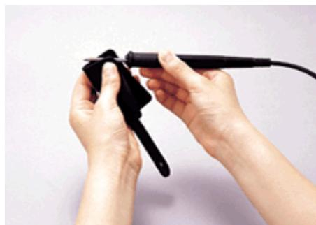
Используя термоизоляционную ухватку, головка просто вынимается из паяльника. При этом естественным образом нагреватель отключается от питания, в отличие от уже упомянутого паяльника PS-90 фирмы PACE, где утверждается, что возможна смена наконечника «на ходу» без выключения инструмента, что вообще-то является нарушением правил техники безопасности.
